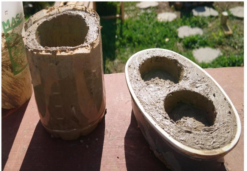
11) N'attendez pas le séchage complet pour démouler votre objet, prenez toute les précautions pour démouler (risque de casse). Les manques de terre peuvent se boucher avec le reste de mortier en l'humidifiant si besoin, les fissures se travaillent avec un pinceau humide jusqu'à la fin du séchage.
