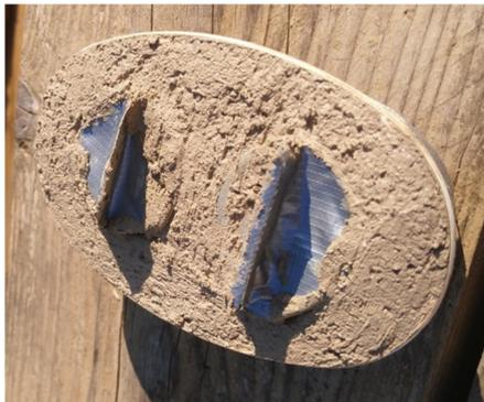
9) Laisser sécher en vérifiant de temps en temps que le mortier ne fissure pas. Quand le séchage commence faite tourner doucement les bougies afin de les retirer de leur logement.
