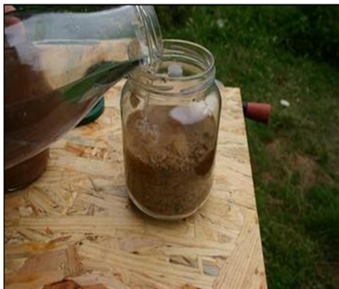
Le sable se dépose tout doucement au fond du pot assez rapidement. L'argile est en surface. L'eau surplombe le tout et devient limpide.
