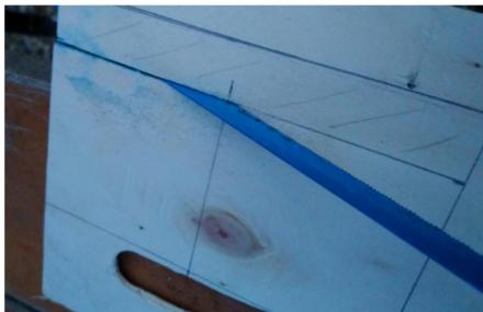
Pour découper avec la pointe du compas, on utilise un montant de la cage comme règle (ou une règle épaisse qui protège votre main de l'outil), puis on trace avec la pointe du compas en y repassant plusieurs fois, pour finir on plie sur le tracé et on sépare avec le ciseau
