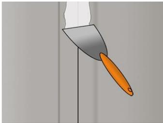
Au niveau de la jointure, vous étalerez une fine couche d'enduit (d'environ 5 cm de large) au couteau, en évitant de faire des rainures ou des surcharges.
