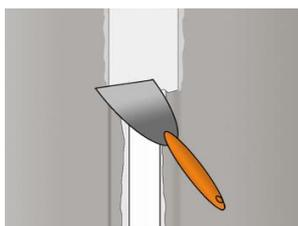
Serrez le calicot sur la jointure en repassant une couche d'enduit.
