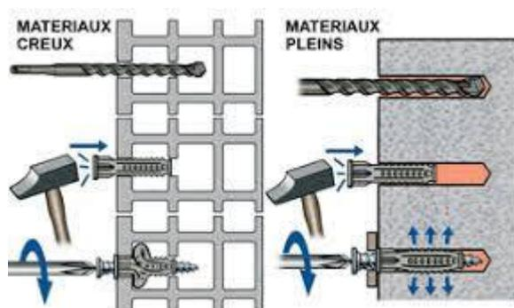
8- Fixation de l'élément pour un élément à fixation directe ou alors fixation des é..... puis de l'élément.
